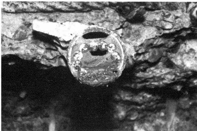
Bild 8. Längskabel im Streifen S2. Schnitt des Kabels direkt vor dem Ankerkopf, Seite Wallisellen. Hohlräume an der Oberseite des Kabels erkennbar
