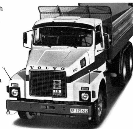
**Volvo N12 Dreiachser:** Gesamtgewicht 25 t, Fahrgestellgewicht inkl. elektr. Wirbelstrombremse ca. 8,2 t. Mit Breitreifen 2,3 m Breite. Mit Doppelbereifung 2,5 m Breite. Spurkreis 15,4 m. Volvo-Ganzstahl-Sicherheitskabine. Motorhaube/Kotflügel aus glasfaserverstärktem Kunststoff. Volvo-Dieselmotor mit Abgasurbolader, 350 DIN/PS, Volvo-16-Gang-Getriebe. Auf Wunsch mit automatischem Getriebe.
