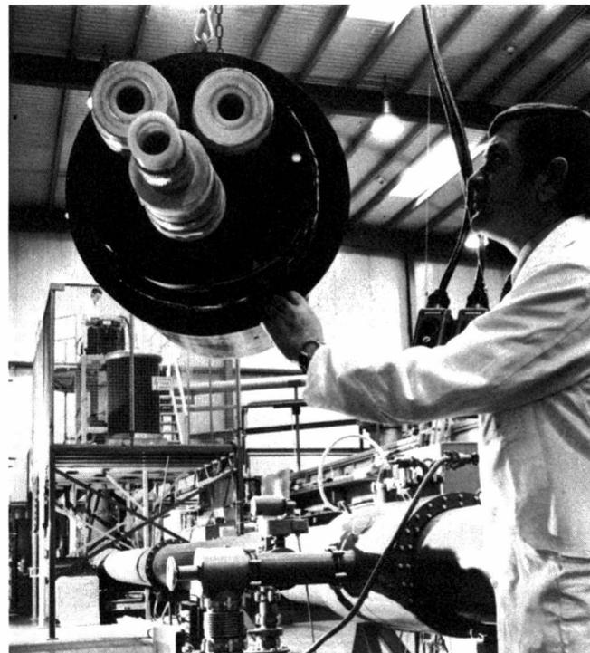
Die elektrische Kabelisolation besteht aus Polyäthylen-Folien. Für die supraleitende Schicht des Leiters wurde reines Niob benutzt. Die dielektrischen wie die Supraleiter-Verluste sind vernachlässigbar klein. Verluste entstehen im wesentlichen nur durch die Wärmeströmung von dem im Erdreich liegenden Aussenrohr auf den heliumgekühlten Leiter; sie belaufen sich unter Berücksichtigung des Wirkungsgrades der Helium-Kältemaschine auf etwa 80 kW/km – das sind 0,004 Prozent der Übertragungsleistung.
