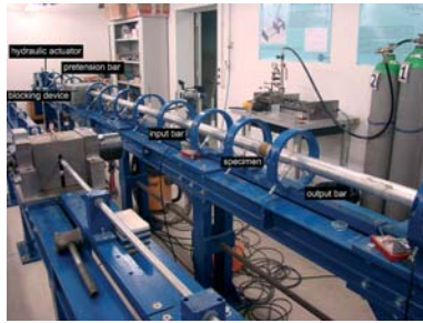
Fig. 4 Installazione dedicata alle prove ad alta velocità di deformazione di campioni di calcestruzzo. Experimental set-up for tensile test on concrete specimen at high strain-rate.
