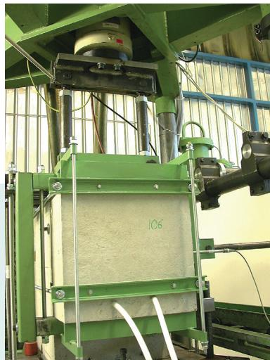
mal belastet. Nach dieser Prüfung auf Gebrauchslastniveau wurde die relative Verschiebung zwischen Oberbau und Unterbau bei einem Wechsel von der minimalen zur maximalen Last gemessen. Danach wurde zuerst die zyklische Belastung gesteigert und schliesslich wurden die Versuchskörper statisch bis zum Bruch weiterbelastet.
