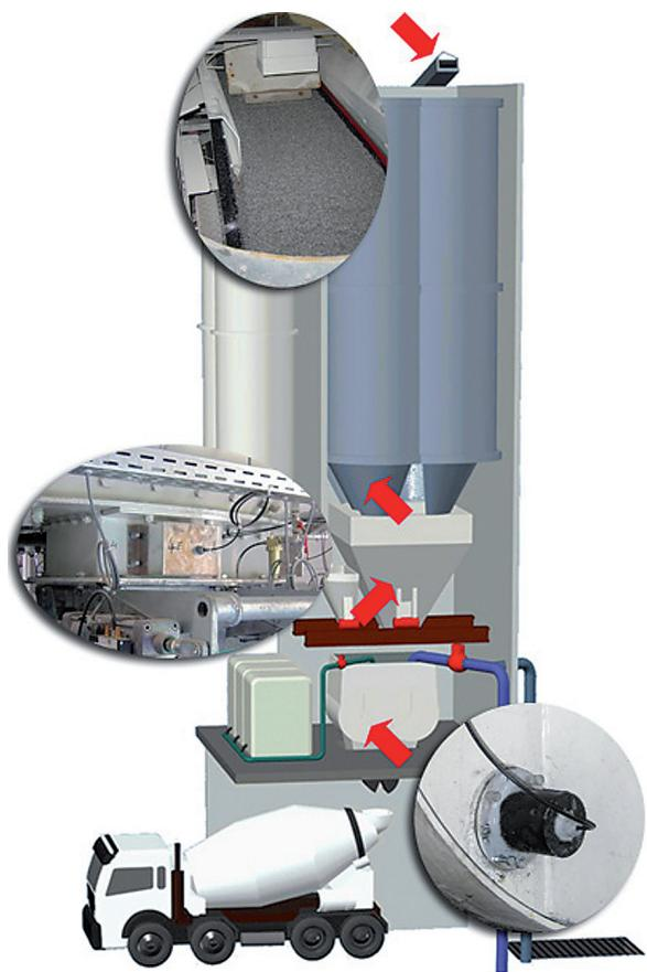
2 Posizionamento dei sensori nella centrale di betonaggio
