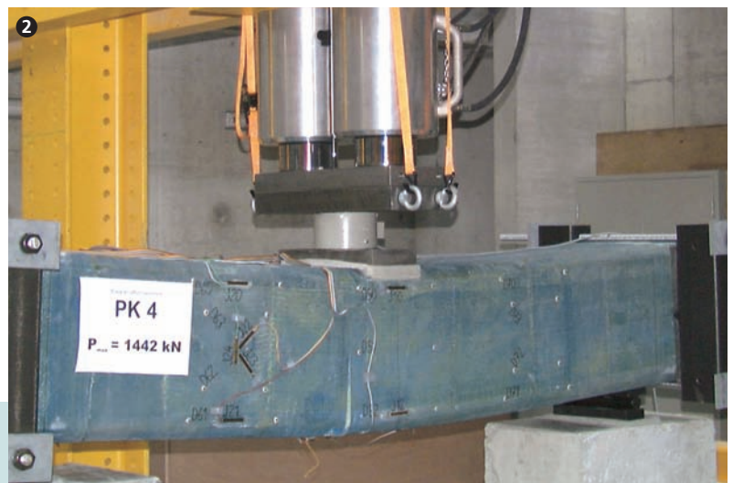
2 Schubversuche an Brückenpfeilern mit nachträglicher Verstärkung durch Aramidgelege. Shear tests on bridge piers with FRP reinforcement (Aramid sheets).
