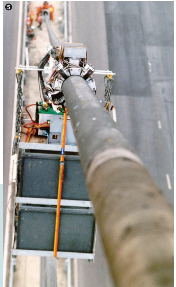
Sicht vom Pylon auf die am Seil angebrachte Prüfapparatur. View from the pylon of the equipment scanning a stay cable.
