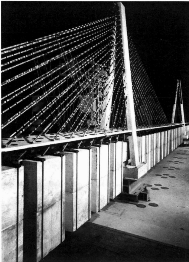
Fig. 9. General view of model 2 with stress-scaled concrete blocks on the deck and steel plates on the cables - Vue générale du modèle 2 avec poids de similitude des charges permanentes du tablier et des haubans - Ansicht des Modells Nr. 2 mit Betongewichten infolge Dauerlast an Fahrbahnplatte und Schrägkabeln
