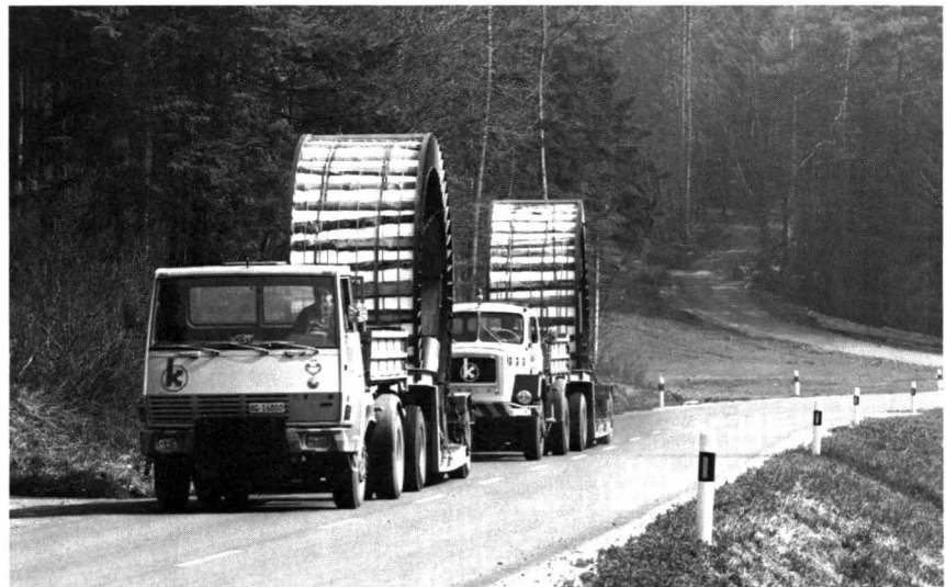
Fig. 10. Transport von Kabelbobinen von Frick nach Basel – Transport de bobines à hauban de Frick à Bâle – Transportation of cable reels from Frick to Basle
